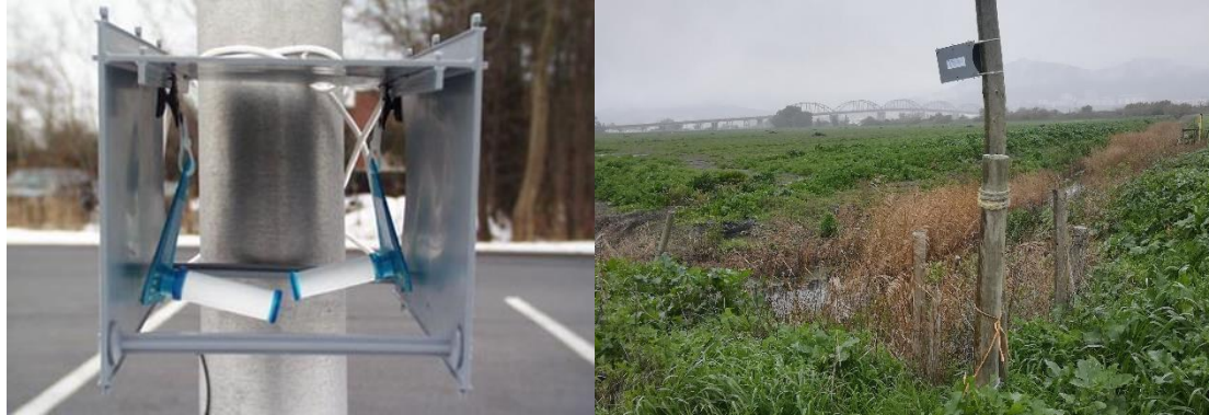
Figura 3 – Instalação de tubos de difusão no terreno
